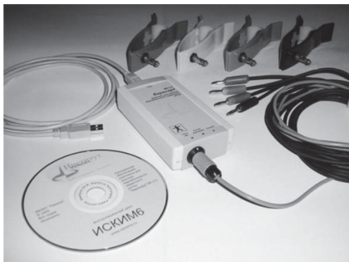
Илл. 1. Аппаратно-программный комплекс «ВАРИКАРД», выпускаемый Институтом внедрения новых медицинских технологий РАМЕНА
