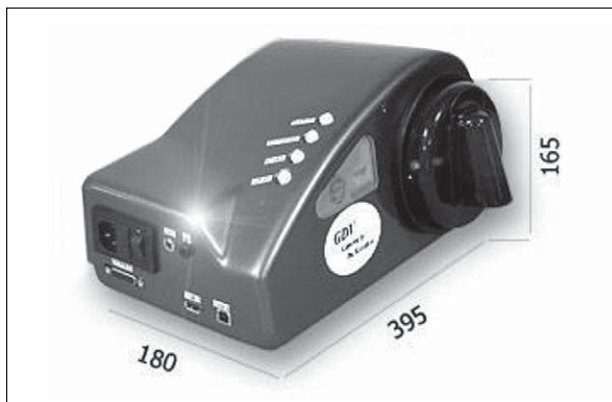
Илл. 2. Современный компьютеризированный прибор «Корона-ТВ», серийно выпускаемый в Институте точной оптики и механики
